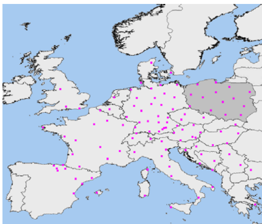
Rys.1. Rozmieszczenie stacji detekcyjnych systemu LINET na terenie Europy [8]
