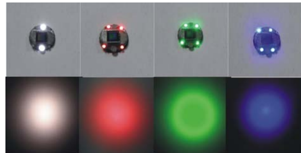
Rys. 3. Widok matrycy użytej do konstrukcji głowicy endoskopowej i światłowodów oświetlających w modelu urządzenia i plamy świetlne uzyskane po bezpośrednim oświetleniu matówki - fotografia wykonana w ciemni optycznej
