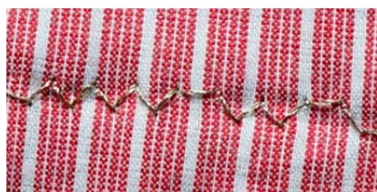
Rys. 4. Ścieg „zygzak” osadzony na rozciągliwym podłożu
