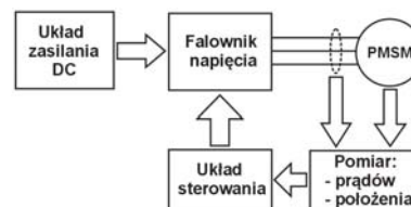
Rys.1. Schemat blokowy napędu elektrycznego z trójfazowym silnikiem PMSM
