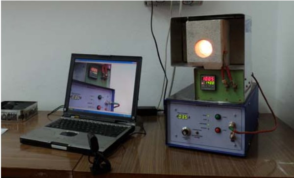
Rys.1. Obiekt regulacji - piec indukcyjny do oznaczania topliwoci popiołu z biopaliw stałych
