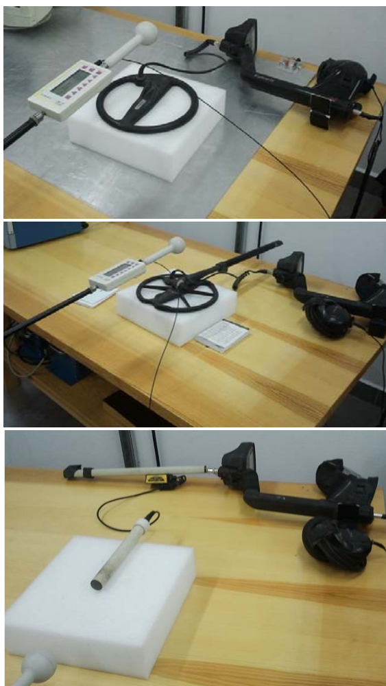
Rys.1. Zdjęcia z badań, widoczne wymienne cewki detekcyjne wykrywacza, od góry: Minelab Explorer SE z fabryczną cewką 10,5 cala, Minelab Explorer E-Trac z cewką 11 cali, Minelab Explorer SE z dodatkowym urządzeniem firmy Sun Ray do detekcji drobnych przedmiotów
