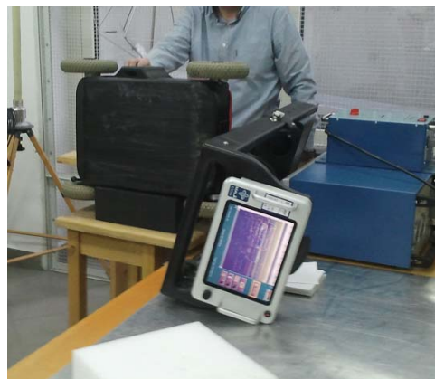
Rys.3. Zdjęcie georadaru Mala GeoScience w trakcie badań emisji elektromagnetycznej
