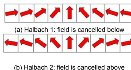
Fig. 2. Halbach magnetization arrays
