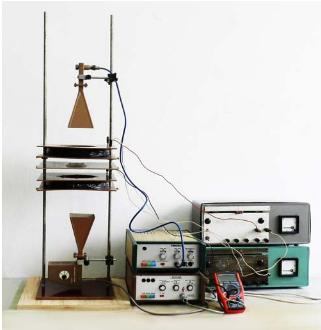
Fot. 1. Wygląd zewnętrzny układu, w którym badano absorpcję mikrofal w ferrofluidach
