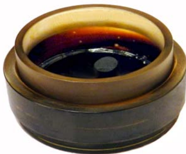
Fot. 2. Wygląd zewnętrzny pojemnika z ferrofluidem
