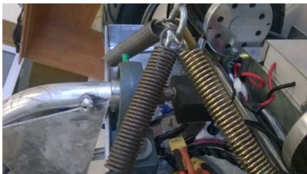
Rys. 4. Mechanizm kierowniczy pojazdu
