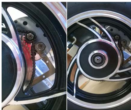
Rys. 3. Widok koła napędowego z przekładnią łańcuchową
