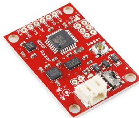
Rys. 8. Inercjalny moduł pomiarowy
