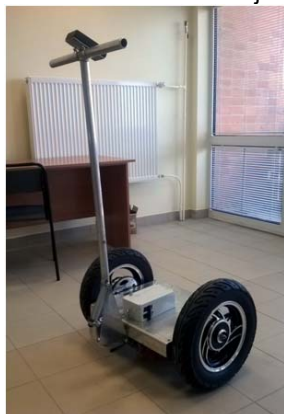
Rys. 1. Dwukołowy samobalansujący pojazd
