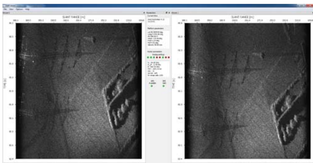
Rys.3 Przykładowe rzeczywiste zobrazowanie radarowe uzyskane podczas lotów (dwukanałowe)
