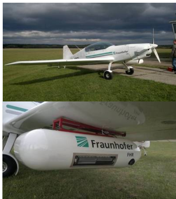
Rys.2. Ultralekki samolot wykorzystywany podczas eksperymentów oraz zasobnik zawierający pod skrzydłem zainstalowany radar SAR
