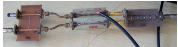
Rys.6 Budowa kwadraturowego detektora częstotliwości na pasmo 1-2 GHz
