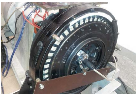
Rys. 6. Laboracyjny zestaw maszynowy z silnikiem PMSM
