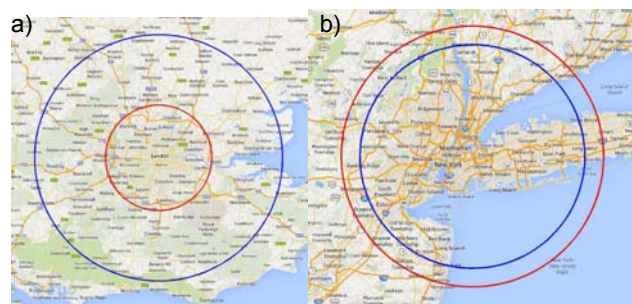
Rys. 3. Zarys plam świetlnych wokół Londynu i Nowego Jorku. Okrąg czerwony oznacza granicę plamy od zwierciadła na orbicie niskiej, okrąg niebieski oznacza granicę plamy od zwierciadła na orbicie na wysokości 13 920 km.
