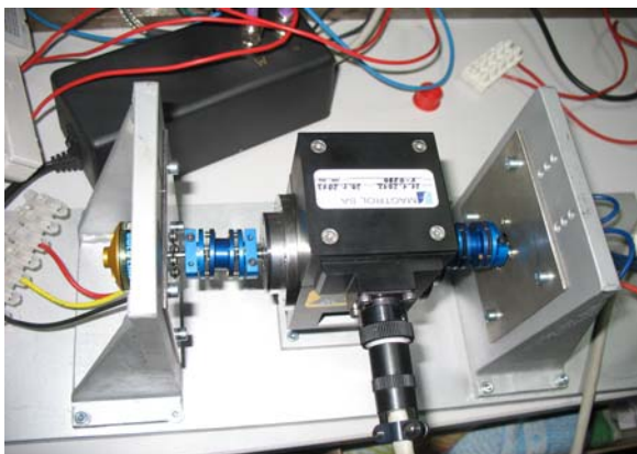
Rys.5. Widok stanowiska do wyznaczania charakterystyk ruchowych badanego silnika BLDC
