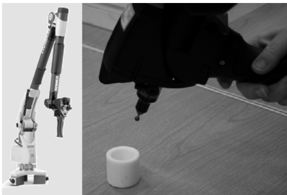
Rys.4. Pomiar ramieniem Romer Arm 7320SE ze skanerem HP-L-20.8 w oprogramowaniu 3D Reshaper
