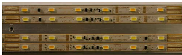
Rys. 1. Elementarny fragment pasków LED o długości 15 cm zamontowanych w modelu oprawy
