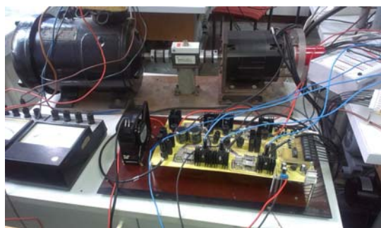
Rys. 12. Stanowisko do badania maszyny reluktancyjnej przełączalnej 8/6
