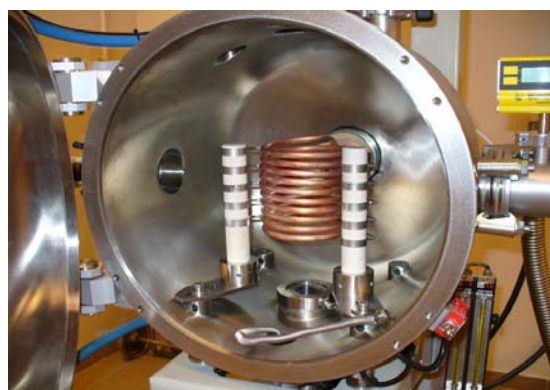
Rys. 2. Wnętrze komory pieca indukcyjnego aparatury MPD w IFJ PAN Kraków
