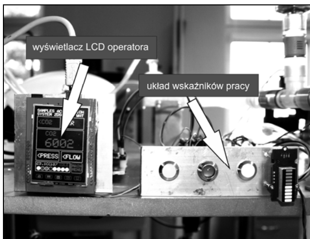
Rys. 4. Widok panelu kontrolnego czujnika CO 2
