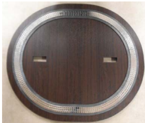
Rys. 7. Tor magnetyczny do badania zjawiska lewitacji magnetycznej z wykorzystaniem nadprzewodnika wysokotemperaturowego
