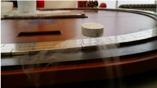
Rys. 8. Nadprzewodnik lewitujący nad torem magnetycznym
