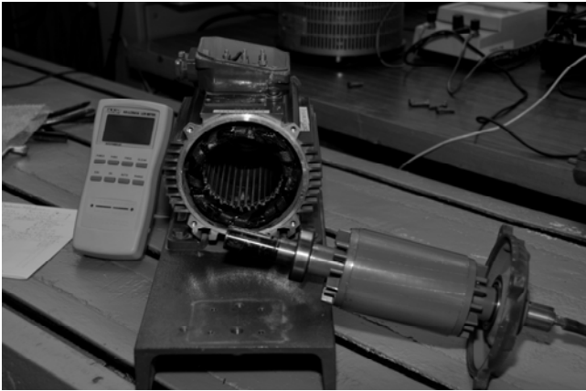
Rys.2. Pomiar parametrów silnika asynchronicznego klatkowego o mocy 1.5kW do wyznaczania składowych przejściowych podczas zwarcia 2-fazowego.
