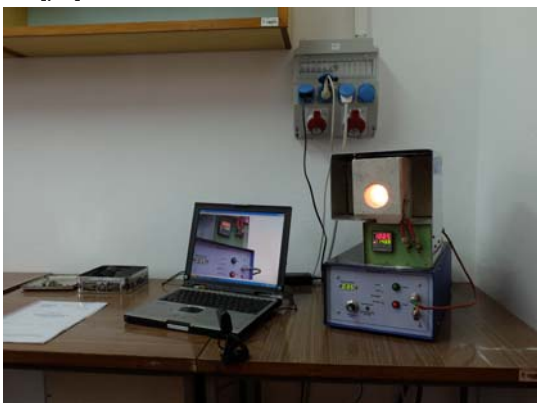
Rys. 2. Zrealizowane praktycznie prototypowe stanowisko laboratoryjne. U dołu układ przekształtnika, powyżej układ wyjściowy, u góry wzbudnik z rurą grafitową.
