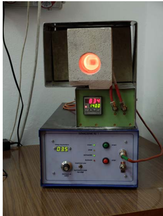
Rys. 3. Zrealizowane praktycznie prototypowe stanowisko laboratoryjne. U dołu układ wyjściowy, u góry wzbudnik z rurą grafitową. W rurze widoczna badana próbka sprasowanego popiołu.
