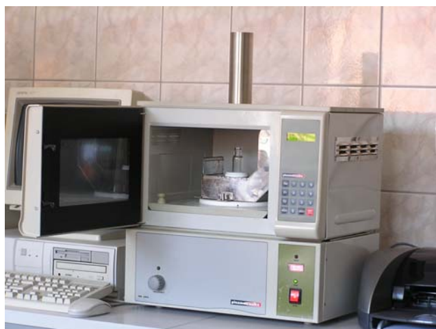
Rys. 2. Reaktor mikrofalowy wraz z przystawką jednomodową jako stanowisko badawcze do generowania skoncentrowanego pola mikrofalowego CMF
