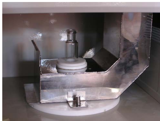
Rys. 3. Widok na przystawkę jednomodową służącą „zagęszczeniu” pola mikrofalowego w tzw. skoncentrowane pole mikrofalowe CMF
