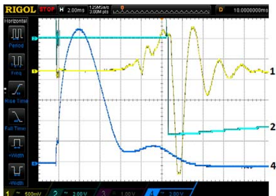
Rys.6. Przebiegi napięcia dla U_s = 220VDC w funkcji czasu
