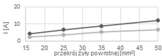
Rys.4. Prąd indukowany w żyłę powrotną w funkcji przekroju żyły powrotnej
