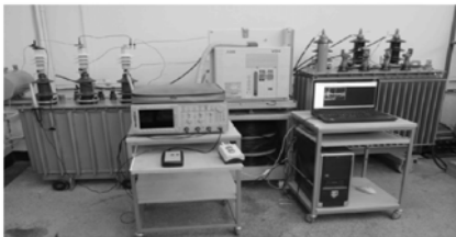
Rys. 2. Widok układu doświadczalnego, stosowanego do rejestracji prądów i wyznaczania częstotliwości rezonansowych prądów propagujących się w typowych układach sieci elektroenergetycznej średniego napięcia
