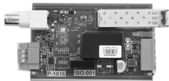
Rys.10. Moduł komunikacji światłowodowej
