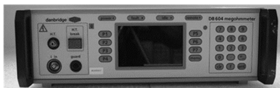
Rys.2. Elektrometr Danbridge DB604; zakres pomiarowy do 3 \times 10^{15} \Omega , U=50\text{-}5000 \text{ V DC}
