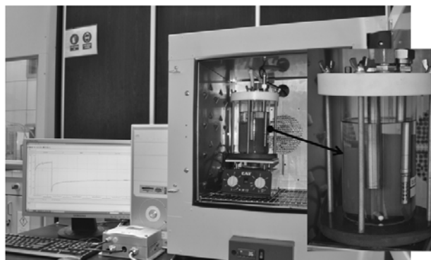
Rys.4. Układ pomiarowy wykorzystany w procesie suszenia celulozy za pomocą estru syntetycznego
