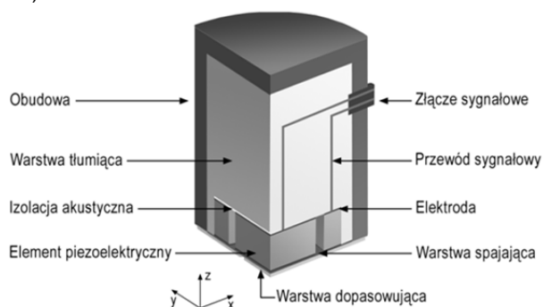
Rys.8. Schemat ideowy piezoelektrycznego przetwornika EA
