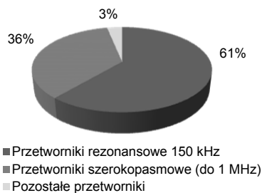
Rys.1. Rodzaje przetworników piezoelektrycznych zastosowanych w badaniach wyładowań niepełnych w izolacji papierowo-olejowej (zestawienie opracowano na podstawie artykułów [10-43] opublikowanych w czasopiśmie i materiałach pokonferencyjnych IEEE w latach 2000-2015)
