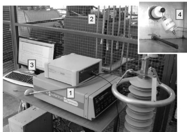
Rys.5. Konfiguracja stanowiska do pomiaru parametrów dielektrycznych ograniczników przepięć: 1) system do szerokopasmowych pomiarów impedancyjnych Solartron 1260+1296; 2) komora termiczna; 3) komputer z programem sterującym pomiarami; 4) obiekt badany (ogranicznik przepięć) umieszczony wewnątrz komory termicznej z przepustami izolacyjnymi
