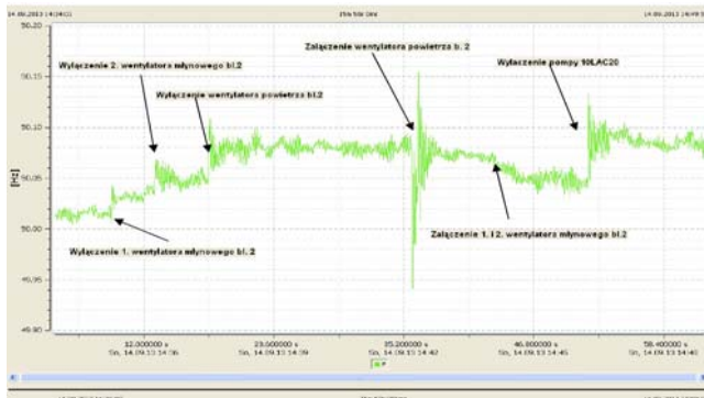
Rys.2. Częstotliwość zarejestrowana w torze wyprowadzenia mocy z bloku BC-50 (110 kV) podczas tworzenia układu wyspowego
