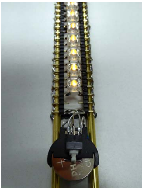
Rys. 4. Świetlny wskaźnik poziomu ciekłego azotu
