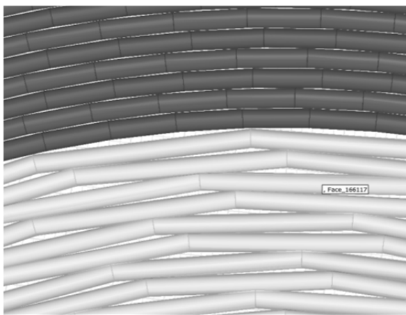
Rys.8. Widok częściowy dwóch cewek, cewka zasilająca (górna część zdjęcia) po minimalizacji odległości poszczególnych warstw oraz cewka pomiarowa o zbyt dużych wolnych przestrzeniach pomiędzy kolejnymi uzwojeniami (dolna część zdjęcia).
