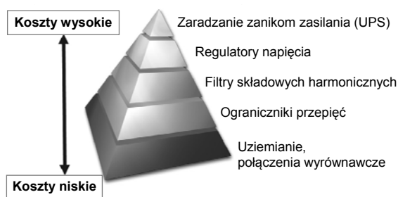
Rys. 1. Piramida kosztów poprawy jakości energii elektrycznej [6]
