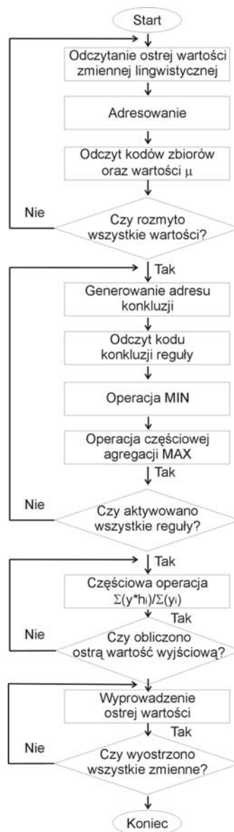
Rys.3. Algorytm działania proponowanego systemu rozmytego, zrealizowany w oparciu o wnioskowanie Mamdaniego typu MIN-MAX
