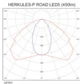
Rys. 4. Widok oprawy HERKULES-P ROAD AT 1J LED 5 firmy HYBRYD oraz jej krzywa światłości [7]
