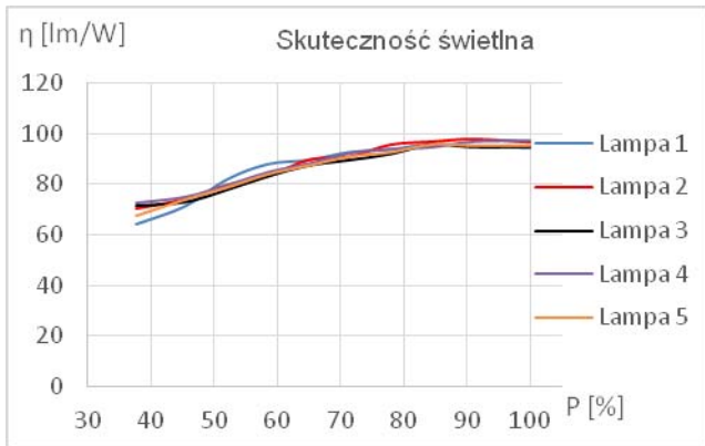
Rys . 2. Wpływ zmian mocy na wartość skuteczności świetlnej układu o mocy 70 W
