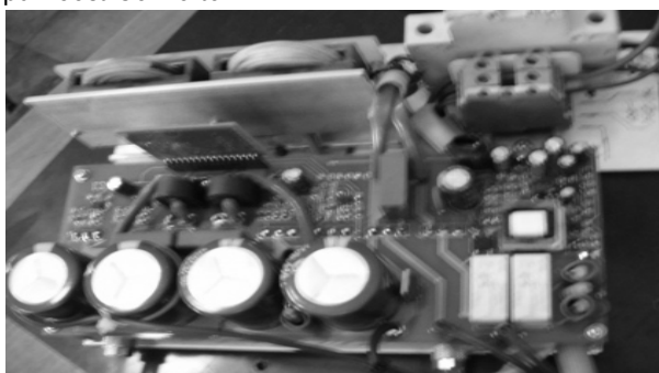
Rys.5 Widok zrealizowanego prototypu korektora współczynnika mocy PFC typu Boost-Converter
