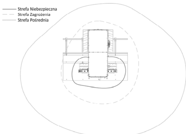
Rys.7. Strefy ochronne w otoczeniu zgrzewarki w.cz. – pomiar składowej elektrycznej
