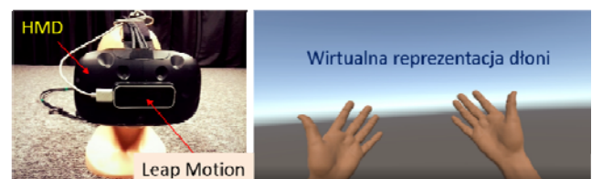
Rys. 5. System LeapMotion do śledzenia ruchów dłoni
