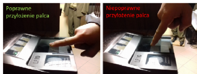
Rys. 2. Ułożenie palca do skanowania linii papilarnych
