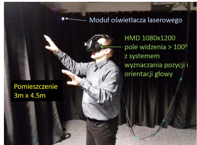
Rys. 4. System pozycjonowania postaci - SteamVR
