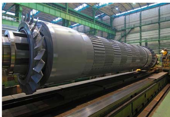
Rys.1. Przykład zmodernizowanego wirnika turbogenerators TWW-200-2 z zabierakowym systemem chłodzenia
