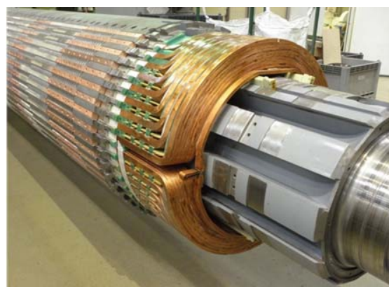
Rys.4. Przykład modernizowanego wirnika turbogenerators TWW-200-2 z osiowo-promieniowym systemem chłodzenia
