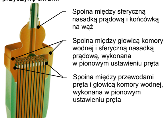
Rys.17. Przykładowy przekrój końca pręta ze sferyczną nasadką prądową
