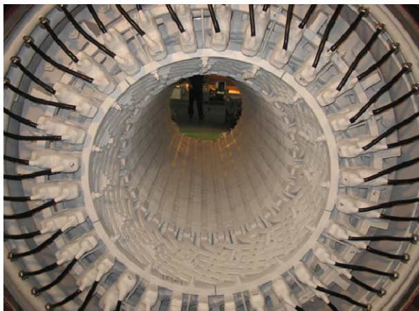
Rys.15. Przykład uzwojonego stojana turbogeneratorskiego TWW-200-2
