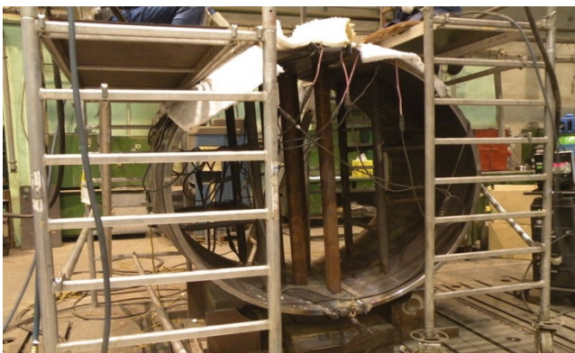
Rys.4. Podgrzewanie wstępne obejmują łopatek
