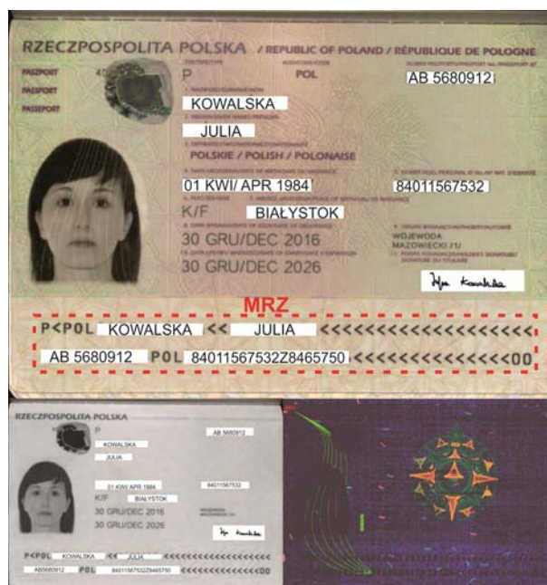
Rys.1. Zdjęcie pierwszej strony paszportu wykonane przez czytnik dokumentów w świetle: widzialnym (zdjęcie górne), podczerwonym (zdjęcie lewe dół) i ultrafioletowym (zdjęcie prawe dół). Ze względu na ochronę danych osobowych prawdziwe dane wycięto i zastąpiono fikcyjnymi.
