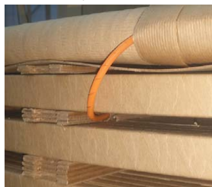
Rys.11. Czujnik światłowodowy umieszczony w uzwojeniach
