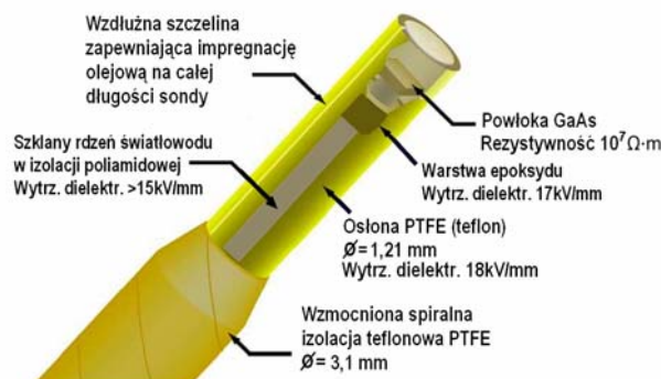
Rys. 5. Wykonanie przewodu światłowodowego przeznaczony do pomiaru temperatury [7]
