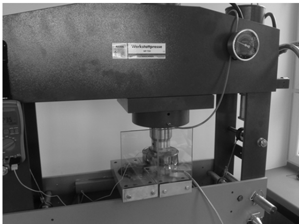
Rys.3. Wytwarzanie próbek kompozytowych – prasa hydrauliczna wraz ze stalową formą i opaską grzejną
