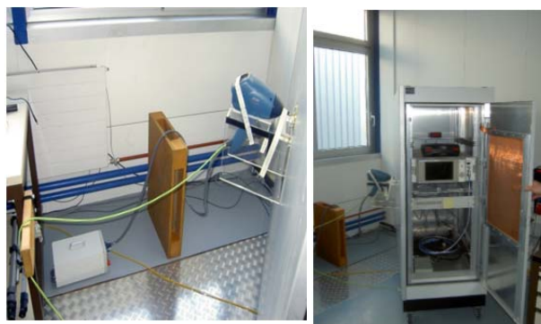
Rys.1. Stanowisko do weryfikacji generatorów ESD
