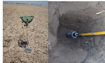
Rys. 4. Widok ogólny penetrometru elektronicznego wyposażonego w sondę wilgotności
