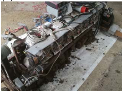
Rys. 3. Widok ogólny urządzenia do mikrofalowej dezynfekcji gleby w czasie pracy
