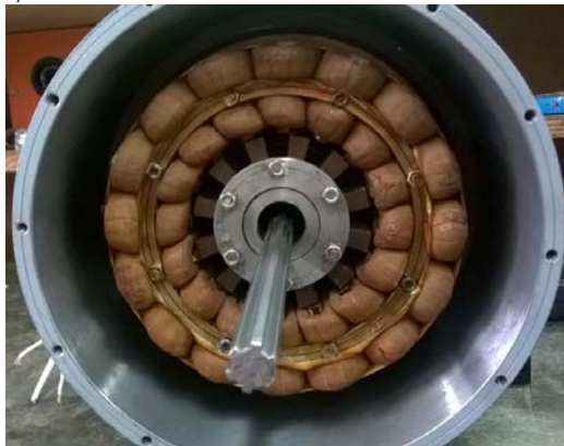
Rys. 4. Widok na uzwojony stojan z wirnikiem wewnętrznym i wałem
