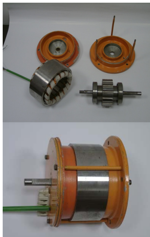
Rys. 2. Model silnika o ruchu liniowym lub obrotowym
