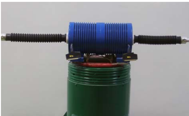
Rys. 10. Model manipulatora o trzech stopniach swobody z silnikiem liniowo-obrotowym typu skokowego z rysunku 8 – wersja I
