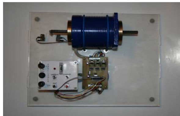
Rys. 5. Silnik typu „śruba rzymska” z układem sterowania
